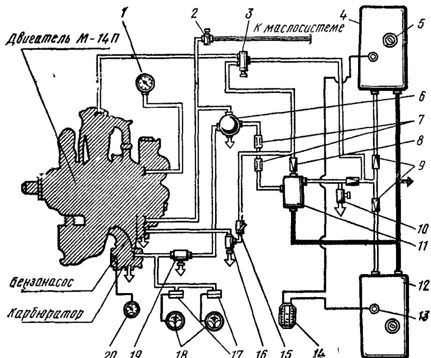
рис. 8 Принципиальная схема топливной системы
