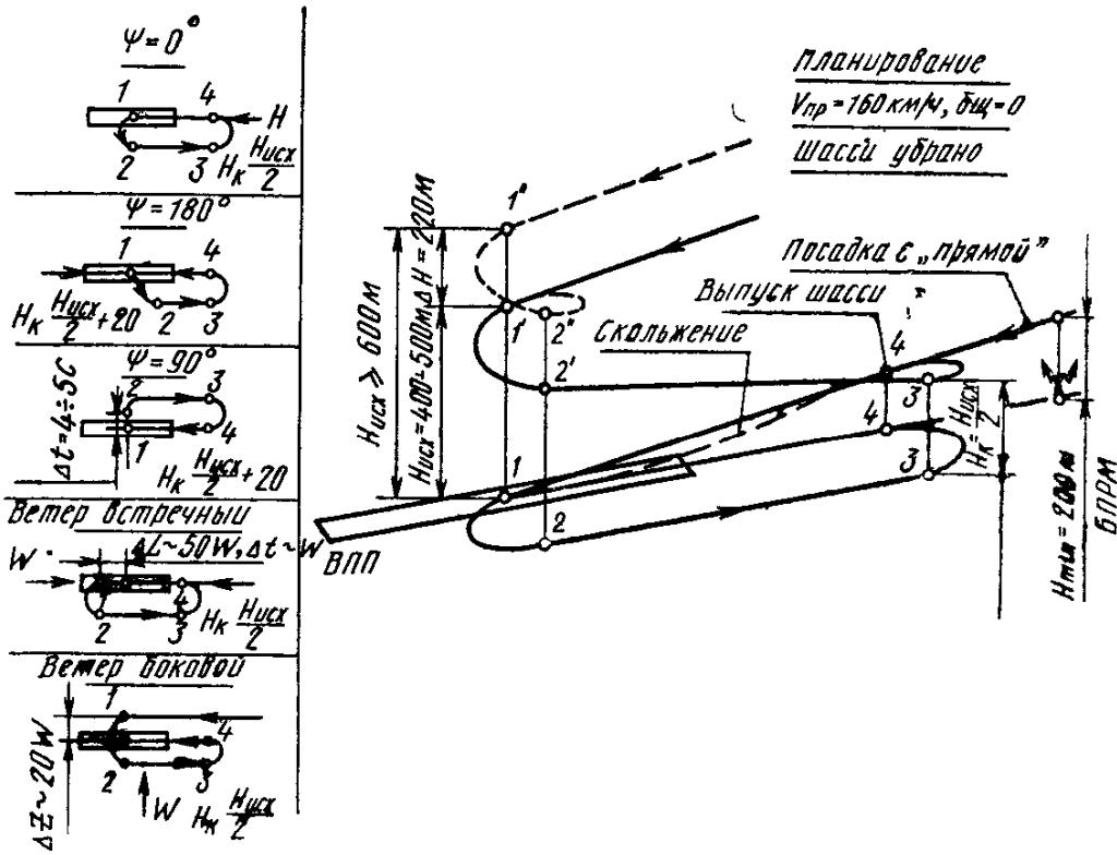
рис. 6 Схема захода на посадку с отказавшим двигателем
