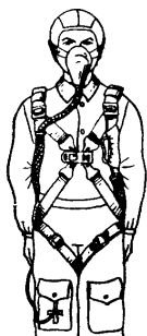
Фиг. 12.5. Кольцо вытяжного троса находится с левой стороны на уровне груди.
