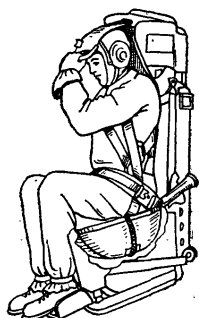
Фиг. 12.1. Схема катапультного кресла со шторкой. Парашют помещен в чашке сиденья.
