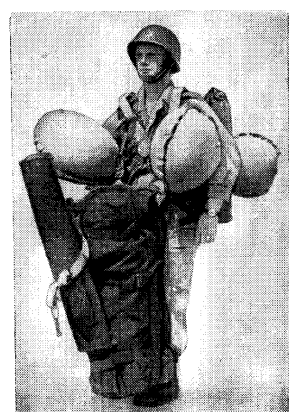
Фиг. 15.6. Десантник американской армии с пневматическими амортизаторами.
